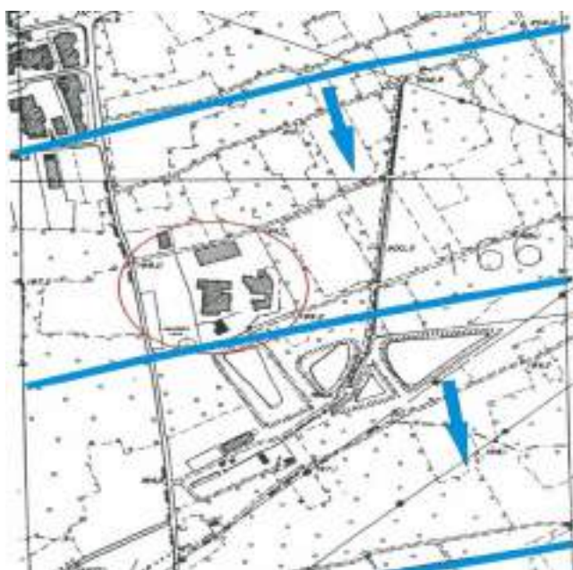
Figura 7 - Piezometria della falda (CTR scala 1:10.000 ingrandita)
